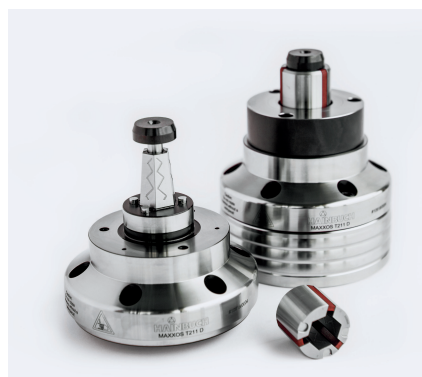
3 Eine Hainbuch-Spezialität ist der sechseckige Spanndorn in Pyramidenform. Er schließt mit verschiedenen Spannbüchsen formschlüssig ab und erlaubt so das prozesssichere Übertragen hoher Halte- und Drehmomentkräfte © Hainbuch
